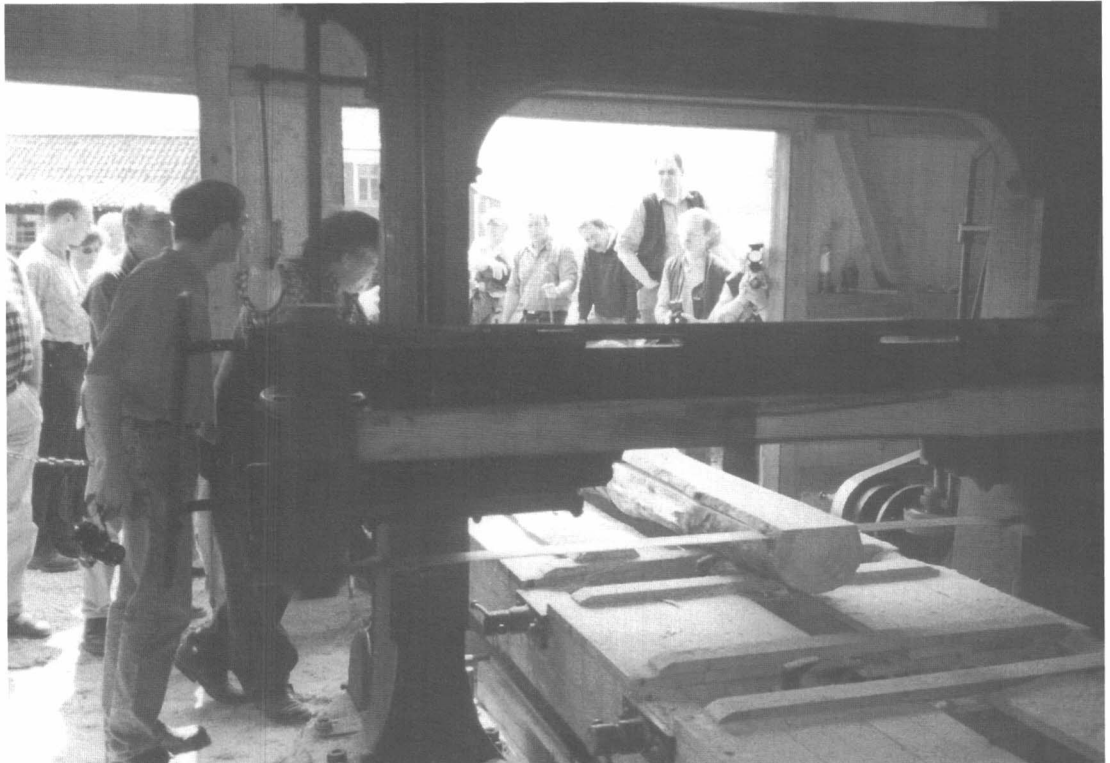
Das Horizontalsägegatter schneidet Baumstämme mit über einem Meter Durchmesser.
