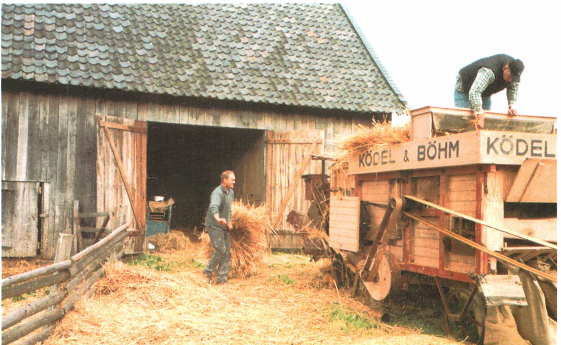
Dreschen mit der Dreschmaschine. Die Dreschmaschine reinigt das Getreide, löst das Korn heraus und bündelt das Stroh. Erst seit Anfang des 20. Jahrhunderts können diese Vorgänge der Ernteverarbeitung schneller und effektiver erledigt werden.
