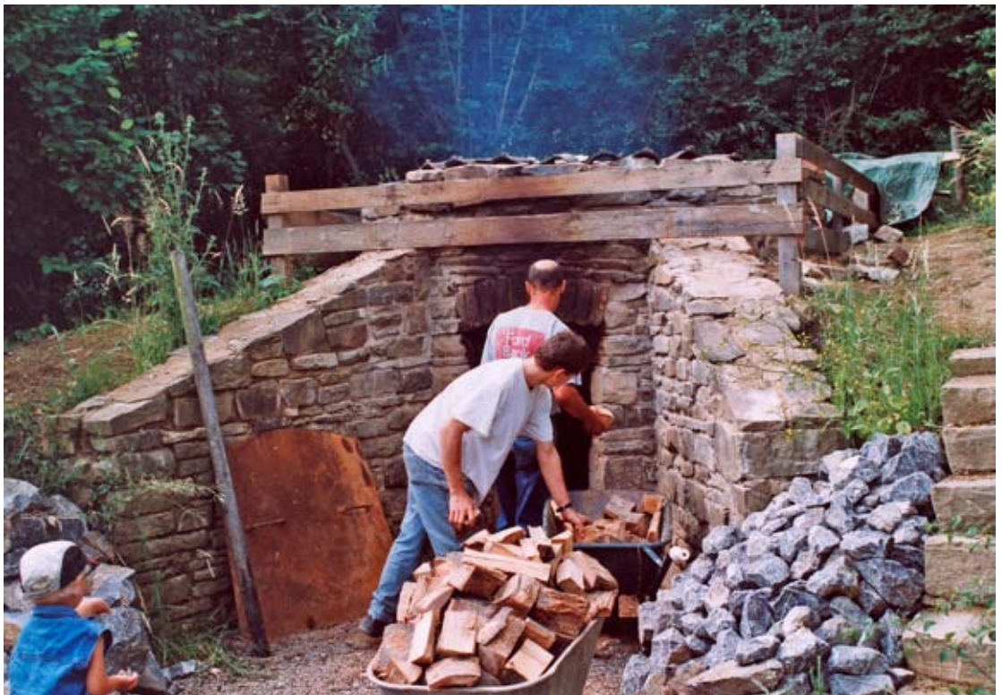
Gut Brand! Langsam wird der Kalkofen mit Buchenholz befeuert, damit sich die Hitze im Ofen gleichmäßig verteilen kann. Aus dem Ofen steigen bereits einige Wasserschwaden auf.
