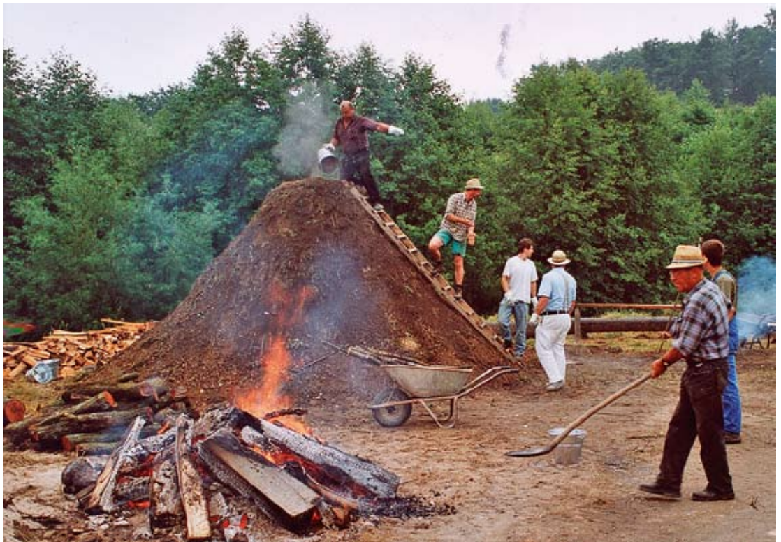
Der Brand beginnt! In den sorgfältig aufgeschichteten und mit einer Mischung aus Erde, Reisig und Sand abgedeckten Meiler, wird von oben die heiße Glut eingeführt.
