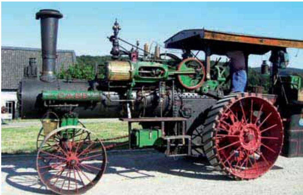
mittels der Lanz-Lokomobile von 1907 konnten so einige Zentner Steine zermahlen werden. Den Transport des Materials übernahm die Feldbahn „Emma“. Doch damit nicht genug, Mitglieder des Clubs bedienten vor der Feldscheune noch einen zweiten Steinbrecher, der Antrieb erfolgte über den Deutz-Stationärmotor aus dem Jahr 1930, der ebenfalls dem Verein gehört.
