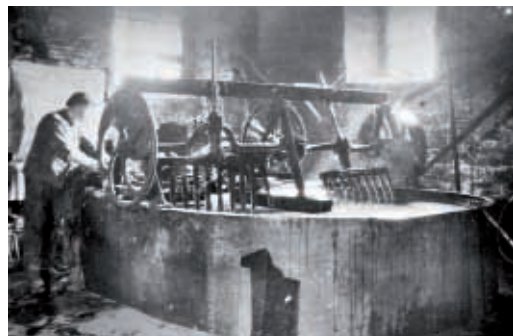
Lumpenwäscher bei der Arbeit in Waldbröl. Ein bedeutender Hersteller der transmissionsbetriebenen Waschmaschinen war der Textilmaschinenhersteller H. Schirp in Wuppertal-Vohwinkel.
