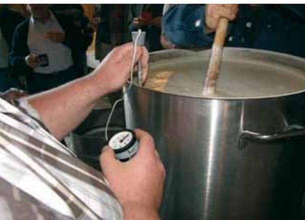
*Unter Temperaturkontrolle wird Malz eingerührt.*
