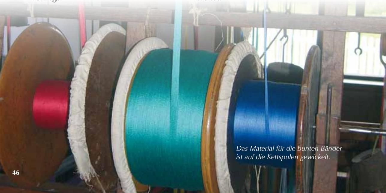
*Das Material für die bunten Bänder ist auf die Kettspulen gewickelt.*
